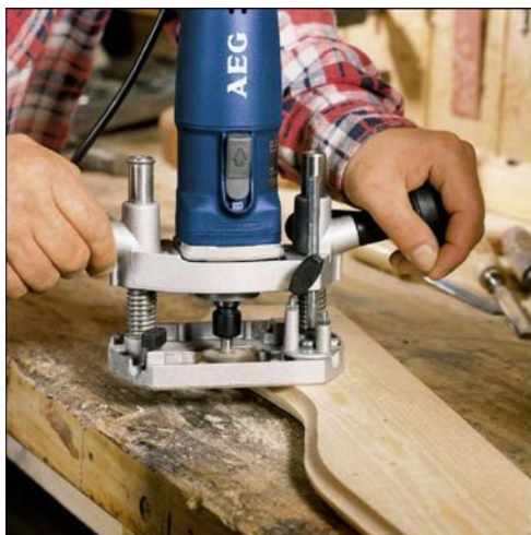
Feuilurage avec un guide parallèle
